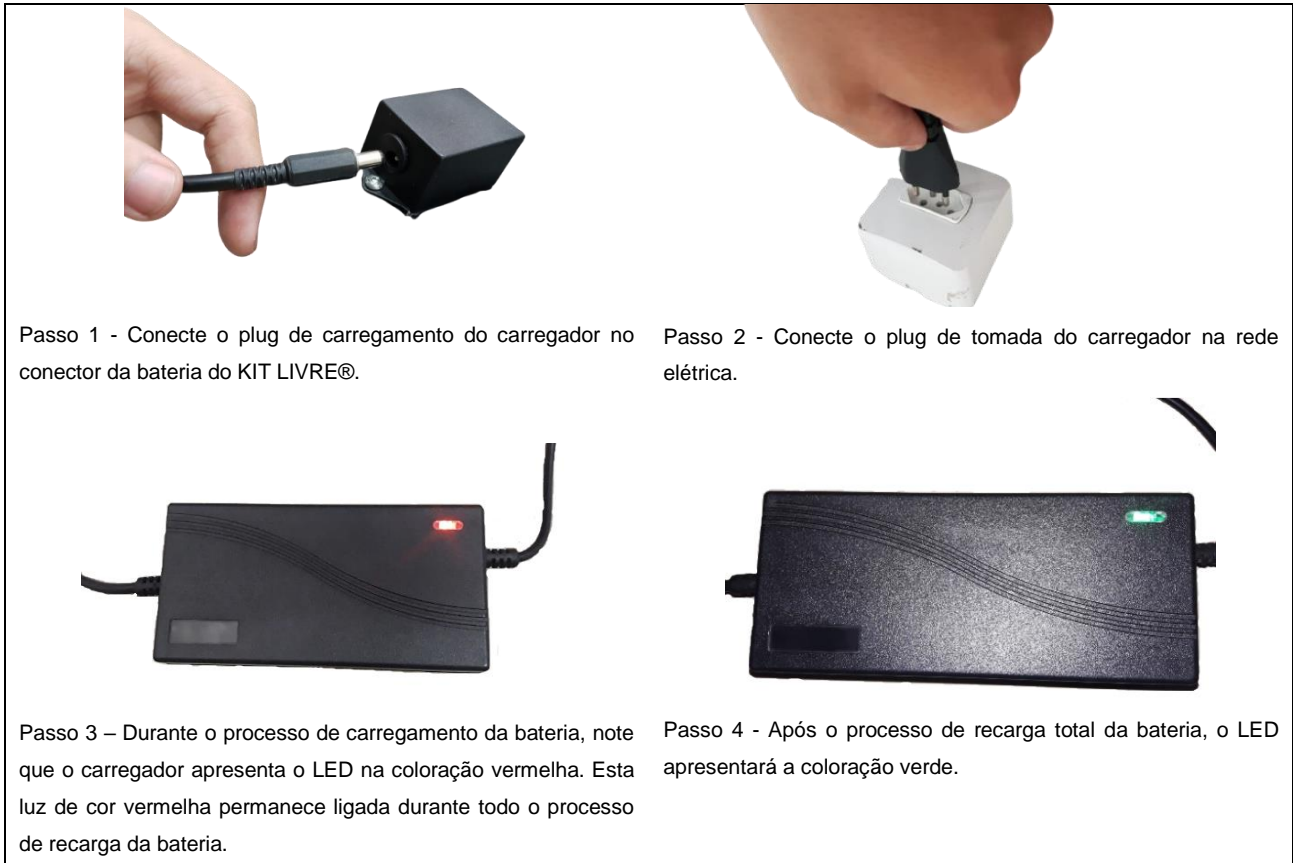
Figura 11 – Processo de recarga da bateria do KIT LIVRE®.
