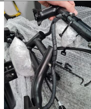
Etapa 19: Com o guidão solto, cobrir a roda do KIT LIVRE® com plástico bolha.
