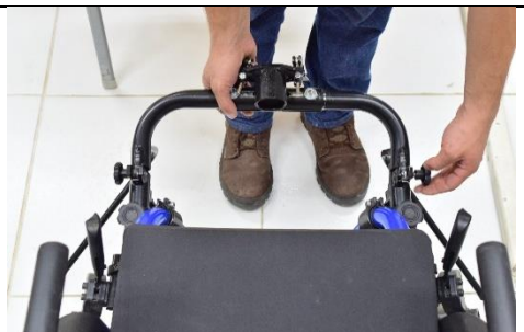
Passo 12: Apertar os manipuladores de ligação (27) dos acoplamentos laterais (17,18).
