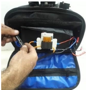
Passo 3 - Desconecte o terminal de conexão da bateria do terminal do controlador.
