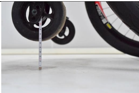
Passo 7: Conferir a altura de levantamento das rodas dianteiras. Recomendável: 8 a 10 cm de altura.
