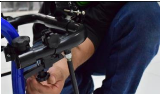
Passo 10: Apertar os manípulos de segurança (1) na parte inferior dos acoplamentos laterais (17,18).
