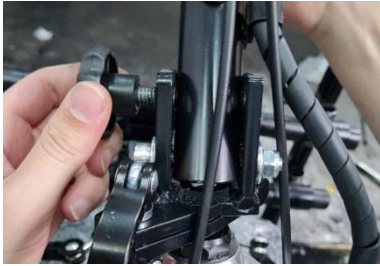
Etapa 12: Retirar o manípulo da coluna de direção.
