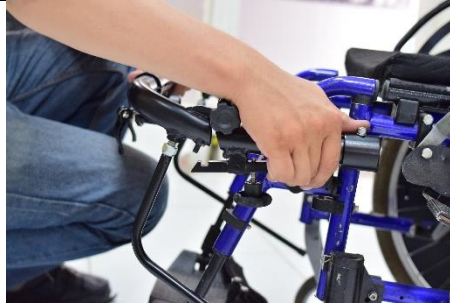
Passo 2: Desarmar os acoplamentos laterais (17,18) e levantar o suporte.
