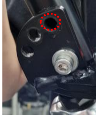
Etapa 13: Utilizar a furação que deixe a coluna de direção reta.
