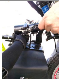
Passo 5 Apertar o parafuso (7) do pino de bloqueagem (5) no centro do suporte.
