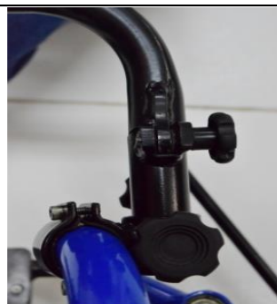
Passo 11: Conferir o alinhamento do suporte junto aos acoplamentos laterais (17,18).
