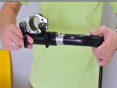
Passo 4: Inserir a curva lado esquerdo (26) no centro do suporte (8).
