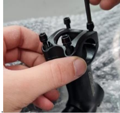
Etapa 21: Fixar os parafusos e a mesa de direção para evitar perdas. Utilizar Chave Allen 4mm.
